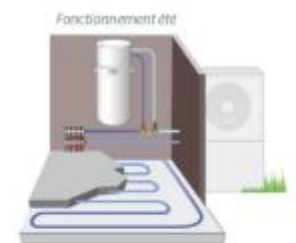
En été, la chaleur gratuite puisée dans le plancher chauffant est restituée à l'eau sanitaire tout en rafraîchissant votre maison.
