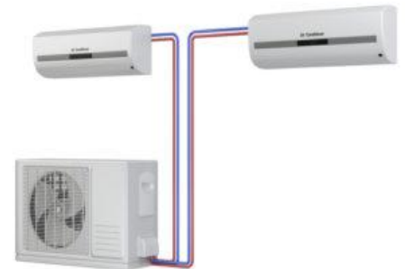
Représentation d'un multi-split associé à 2 unités intérieures
