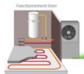
En hiver, le chauffe-eau thermodynamique Edel EAU prélève les calories gratuites de l'air extérieur, par l'intermédiaire du générateur qui alimente le plancher chauffant pour produire l'eau sanitaire à 60°C.
