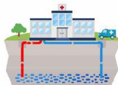
Captage sur nappe (système ouvert) Source : afpg
