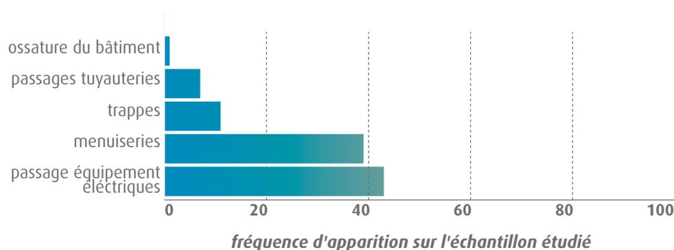
*Graphique : fréquence d'apparition des fuites sur un échantillon de 74 logements construits en structure lourde à isolation thermique intérieure (source : CETE du Sud-Ouest - Litvak, 2005). Il est important de signaler que la fréquence des fuites et leur intensité ne sont pas nécessairement corrélées.*
