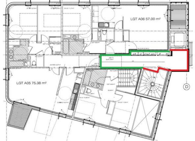
Linéaire entre logements et local non chauffé (en vert) > linéaire entre local non chauffé et extérieur ou autres locaux non chauffés (en rouge) ?
